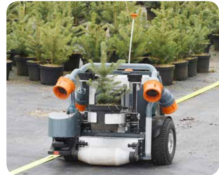
Baumschulroboter HV-100 im Einsatz
